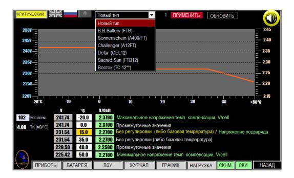
При создании новой батареи устанавливается несколько точек соответствия выходного напряжения и температуры, при этом формируется график, по которому выпрямитель будет отрабатывать задание. Новые данные записываются в энергонезависимую память и после перезагрузки панели управления график восстанавливается.
